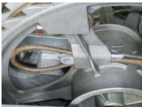
Abb. 22: Schleife mit Keil an der kleinen Trommel
